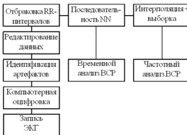
Рис. 7. Диаграмма, суммирующая последовательность шагов при записи и обработке ЭКГ-сигнала с целью получения данных для анализа ВСП.
